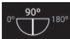
図2-8 モニタ上に表示されるスキャン面インジケータ
