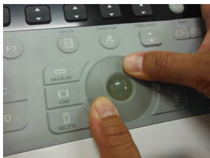
図 8-2: トラックボールのフタを外す
