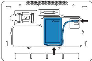
7. Disporre la seconda batteria nel vano batteria come mostrato, quindi collegare il relativo cavo al connettore. Assicurarsi che il cavo sia completamente inserito nel vano.
