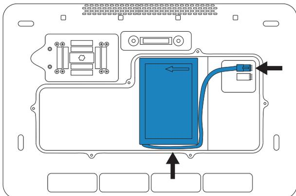
7. 如图所示将第二块电池放入电池舱中，然后将其线缆插入连接器中。确保线缆完全放入电池舱内。
