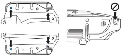
5. 小心抬起显示器底座以及与显示器相连的托盘。将其置于安全的地方。
