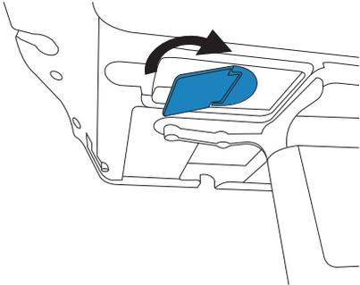
2. 使用塑料撬挖工具拆下显示器底座和托盘中央的封罩。
