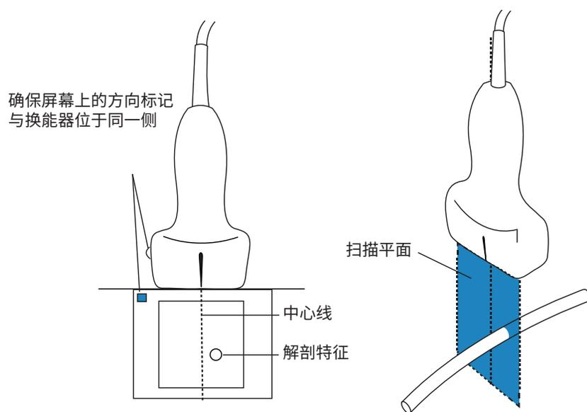
探头的小幅倾斜或旋转都可能影响任何外部参考点与超声波图像上显示的解剖构造之间的关系。
