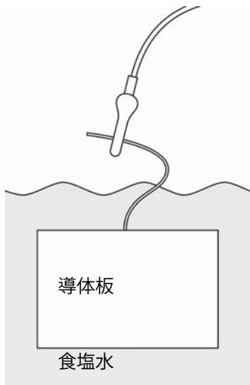
図 5-8 導体板にリード線を接続する
