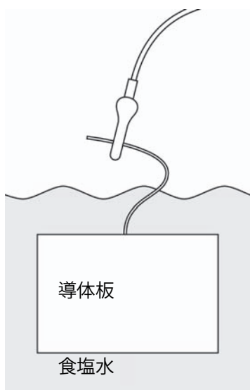
図 5-4 導体板にリード線を接続する
