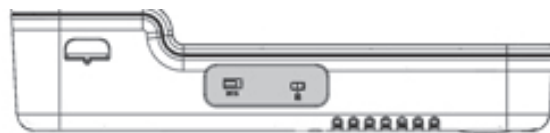
図 4 本体左側面：ECG ポートおよびケンジントン盗難防止用ロック装着用のスロット（灰色の部分）
